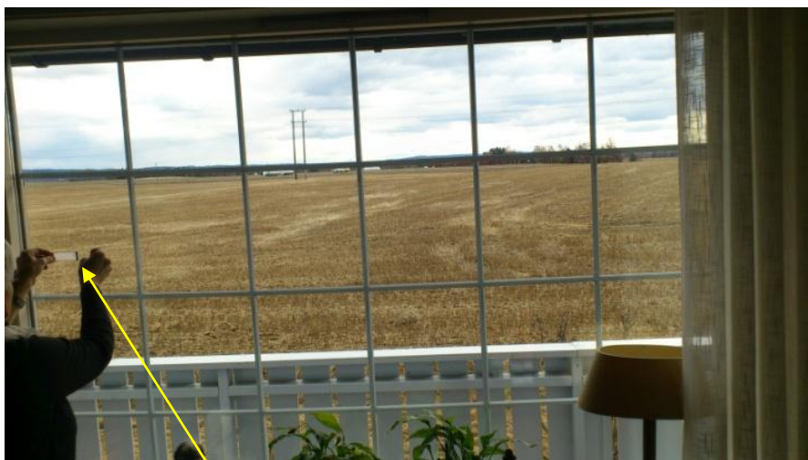
Fig. 6 viser prøvetaking med teip på vindusflaten inne i boligen.
