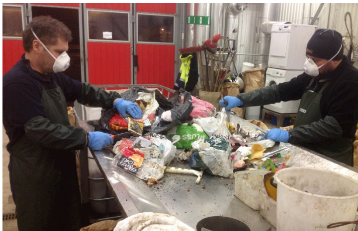
Bilde 1. Avfallet sorteres for hånd ved Envir's avfallslaboratorium
